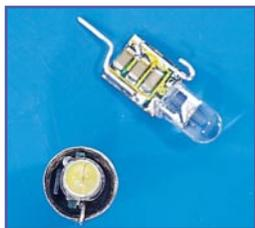
**Bild 4: Miniaturplatine mit einer LED in E-10-Fassung**
