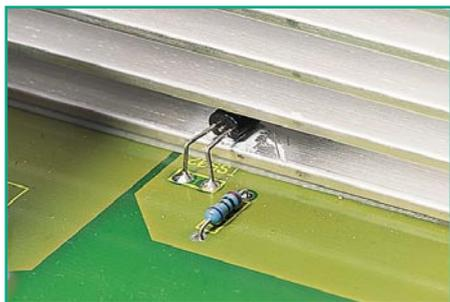
**Bild 11: Montage des Temperatursensors TS 502 im Kühlkörper**
