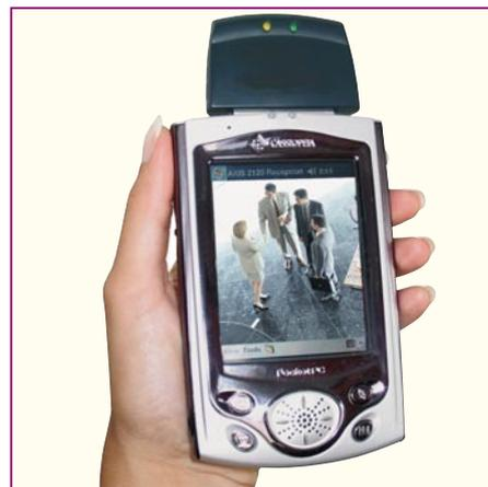
**Bild 6:** Auch so kann Videoüberwachung aussehen - per Wireless LAN arbeitet ein PDA als Client.
