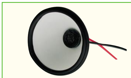
Bild 6: Experimentieranordnung für ein Stethoskop-Mikrofon. Deutlich erkennt man die Gummilagerung der Mikrofonkapsel und die dicke Gummidichtung für den luftdichten Abschluss.
