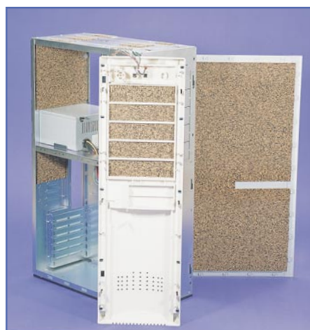
Bild 1: Eliminiert wirkungsvoll Körperschall - voll gedämmtes PC-Gehäuse
