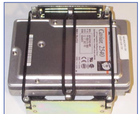
Bild 2: So in einen Spezialrahmen zwischen zwei stabilen Gummibändern eingespannt, werden erfolgreich tieffrequente Schwingungen der Festplatte eliminiert.
