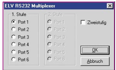
Bild 4: Adresseinstellung für den ELV RS-232-Multiplexer
