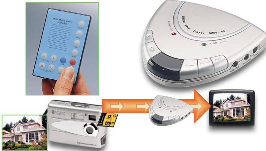
**Bild 1:** So werden immer öfter die Bilder von Digitalkameras gezeigt: Entweder ist die Kamera direkt an den TV-Bildschirm oder Beamer angeschlossen oder ihr Speichermedium wird, wie hier gezeigt, in einen transportablen Leser gesteckt, der das Videosignal erzeugt - Dia-Bildwerfer ade!
