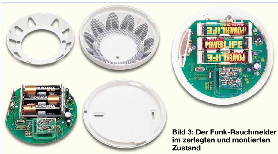
**Bild 3: Der Funk-Rauchmelder im zerlegten und montierten Zustand**
