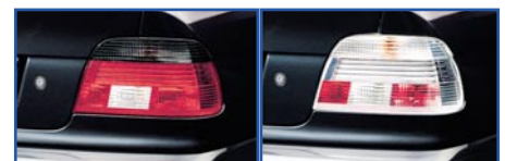
Bild 17: Flexible Lösung: Mit LED- und Lichtleittechnik können den Leuchtfeldern unterschiedliche Aufgaben je nach Situation zugeordnet werden. Bild: Hella KG
