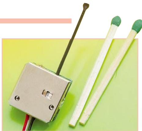
**Bild 1: Videosender mit integrierter Kamera und Mikrofon**
