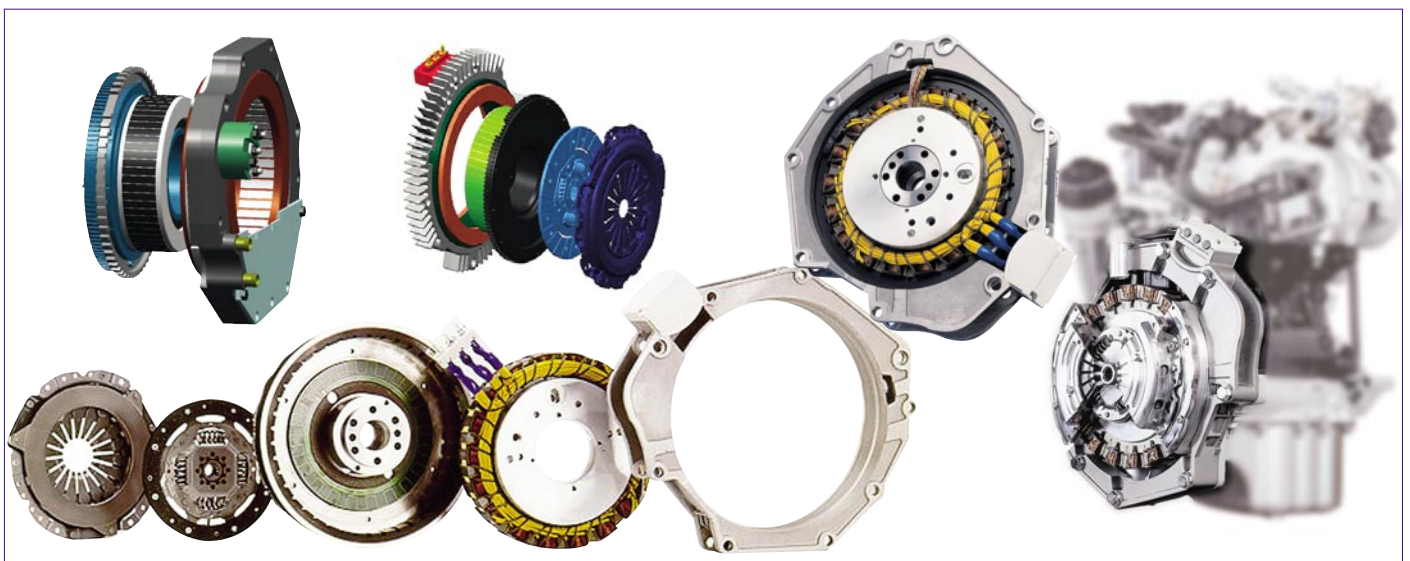
Bild 4: So sind die integrierten Startergeneratoren aufgebaut. Sie enthalten eine zweite, automatische Kupplung. Computergrafiken oben: Valeo; Fotos unten/rechts: Sachs
