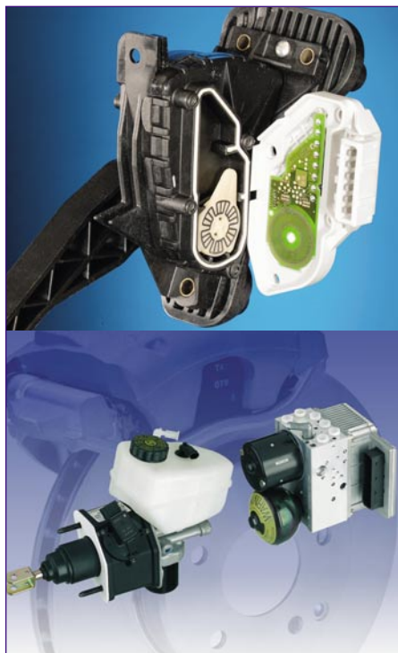
Bild 1: Drive-by-wire ist zum Teil schon Realität: oben das elektronische Gaspedal von Hella, unten die Pedal- und Zentraleinheit der elektrohydraulischen Bremse von Bosch.
