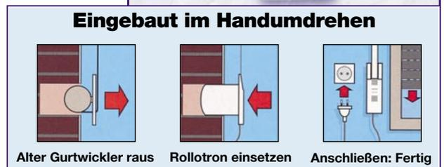
**Bild 23: Klimasteuerung mit Rollläden: Einfach nachzurüstender Unterputz-Rollladenantrieb.**
