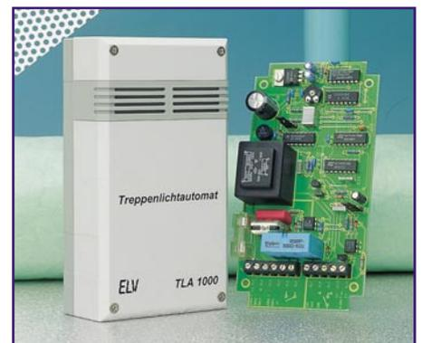
**Bild 16:** Gegen Vergesslichkeit, spart Strom: Treppenlichtautomat zum Nachrüsten.
