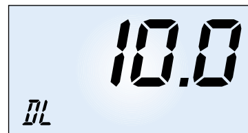
Bild 11: Sturmklängelsperre - hier ist eine maximale Klingelzeit von 10 s eingestellt. Danach schaltet das Relais die Klingel ab.
