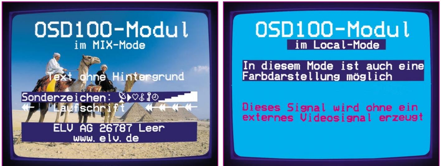
**Bild 6: Die Bildschirmfotos zeigen die beiden möglichen Betriebsarten des OSD 100-Moduls: Mix-Mode und Local-Mode (Erläuterung siehe Text).**
