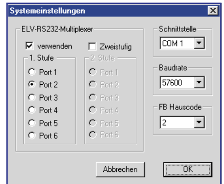
Bild 6: Das Einstellfeld für die Systemeinstellungen. Links das Einstellfeld bei Einsatz des ELV-RS-232-Multiplexers, rechts die Felder für die Wahl der PC-Schnittstelle, der Übertragungsraten und des Bedienstatus der Funk-Fernbedienung.
