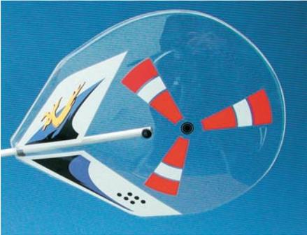
**Der Heckrotor ist nur durch das Dekor angedeutet. Der Hubschrauber erhält seine Stabilität durch die große Heckflosse.**
