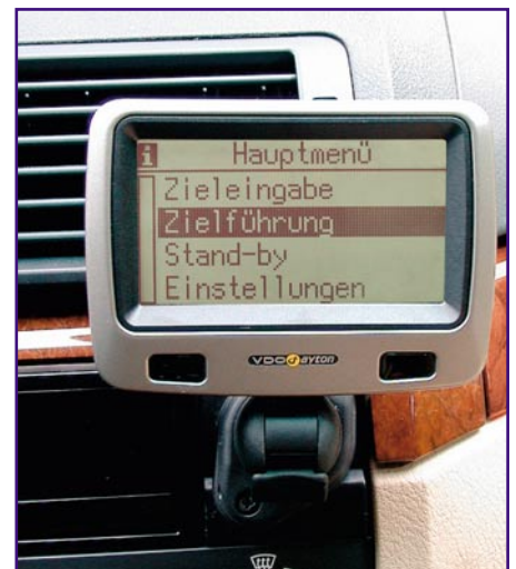
Bild 25: Passt: Die Radioblende sorgt für optische Anpassung und trägt den Monitor des Navigationssystems.
