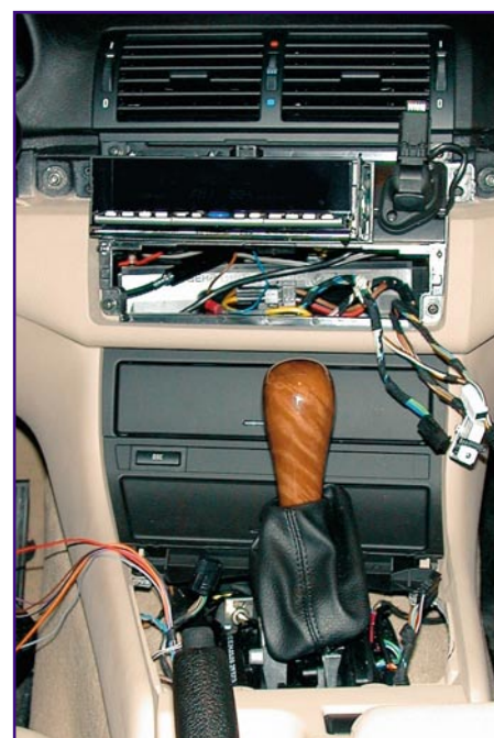
Bild 26: Wenn möglich, alles ringsum abbauen - hier wurde das Steuerteil der Klimaanlage entfernt, um das Radio besser einbauen zu können.
