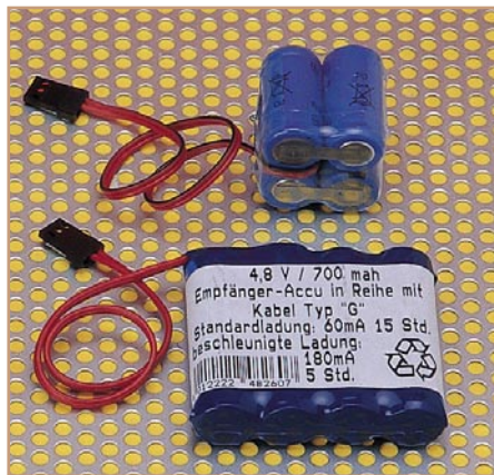
Bild 16: Besser als der Batteriekasten - ein 4,8-V-Akkupack. Es kann zum Laden im Fahrzeug bleiben, da es im Gegensatz zum Antriebsakku für einen ganzen Fahrtag und länger „hält“.
