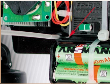
Bild 20: So erfolgt die Antennenmontage.
