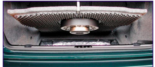
Bild 21: Das Einlegen der neuen Schallwand mit montiertem Subwoofer.
