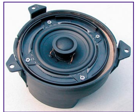
Bild 17: Mit einem MDF-Ring wird der 100-mm-Koax-Lautsprecher im Lautsprechertopf der Heckablage eingebaut.
