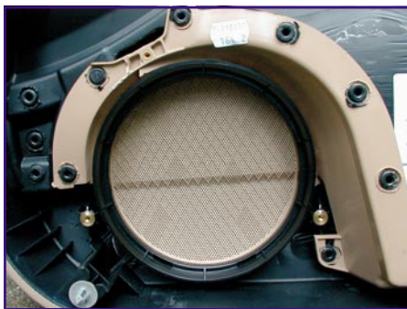
Bild 11: Original-Türmontageplatz mit Ringeinsatz
