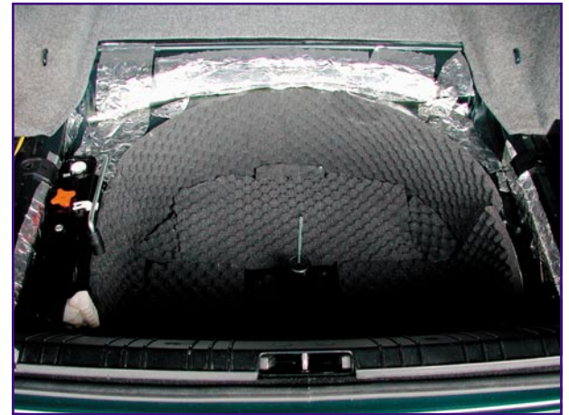
Bild 20: Die gedämmte Reserveradmulde. Das (Not-)Reserverad kann heute auch einem Pannensprayset weichen.
