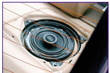
Bild 18: Nur noch das Serien-Abdeckgitter drauf, dann sind auch die Hecklautsprecher unsichtbar.
