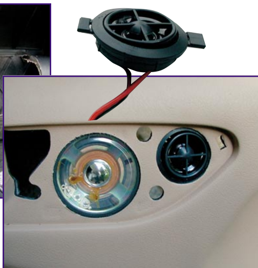
Bild 12: So werden Tweeter und Lautsprecher für Freisprechen und Navigation montiert.
