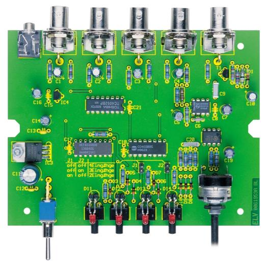
Ansicht der fertig bestückten Platine mit zugehörigem Bestückungsplan des 4-Kanal-Kamera-Multiplexers KM 100
