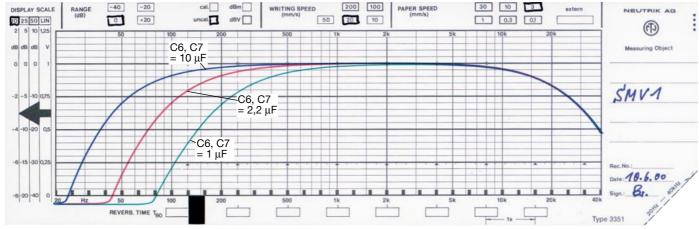
Bild 2: Frequenzgang für verschiedene Werte von C 6 und C 7
