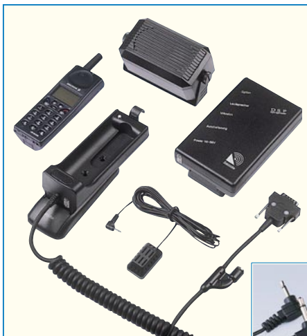
Bild 24: Für Festeinbau - Profi-Freispereinrichtung, rechts das VDA-Kit für die Einbindung in VDA-vorbereitete Fahrzeuge
