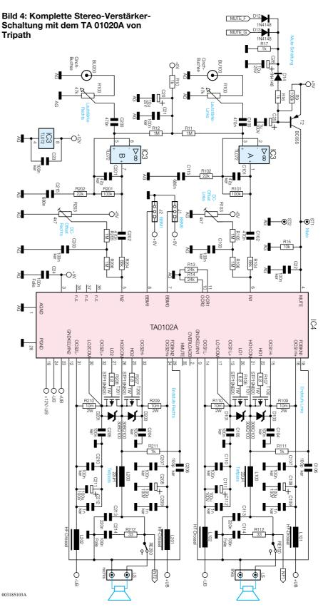
In Form von Rechteck-Impulsen, bestehend aus einer Serie von High- und Low-Signalen, mit gleichbleibender Amplitude, steht das digitalisierte Audio-Signal des linken Kanals an Pin 22, Pin 20 und das Digital-Signal des rechten Kanals an Pin 25, Pin 27 zur Verfügung.
