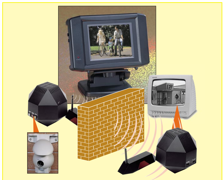
Bild 8: Mit 2,4 GHz durch die Wand: die Funktechnik ermöglicht den eigenen Fernsehsender im Haus. Ein LCD-Monitor erlaubt auch die mobile Überwachung.
