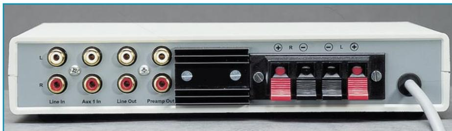
**Bild 2: Die Rückseite des Verstärkers mit den Cinchbuchsen für NF-Ein- und Ausgänge und den Klemm-Lautsprecherterminals. In der Mitte ist der Kühlkörper für den Endstufenschaltkreis zu sehen.**
