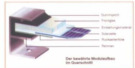
**Bild 3: So entsteht schichtweise ein gut geschütztes und mechanisch stabiles Solarmodul.**
