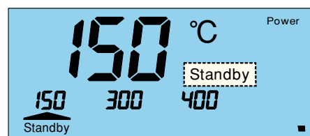
Bild 3: Die LS 50 befindet sich im Standby-Modus
