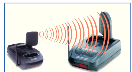
Bild 22: Das Funk-A/V-System spart bei einer Einzelteilnehmeranlage das lästige Antennenkabel in die Wohnung.
