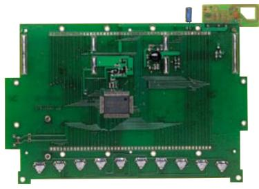
Bild 19: Kompakt, aufgeräumt, aber dennoch mit High-Tech bestückt - so präsentiert sich die WS 2000 von innen. Rechts oben der Funk-Empfänger.
