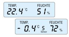
Bild 15: Die Grundanzeigen der Anzeigefelder für Temperatur. Im Außensensorfeld kommt noch die Anzeige des gewählten Sensors hinzu.
