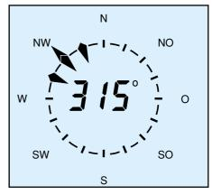
Bild 18: Alternativ zur Windstärke ist die Anzeige der Windrichtung als Digiatalanzeige im 360°-Kreis möglich.
