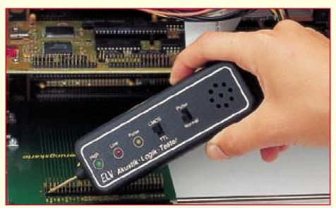
Bild 60: Unentbehrliches Testgerät - Logikpegeltester ALT 3
