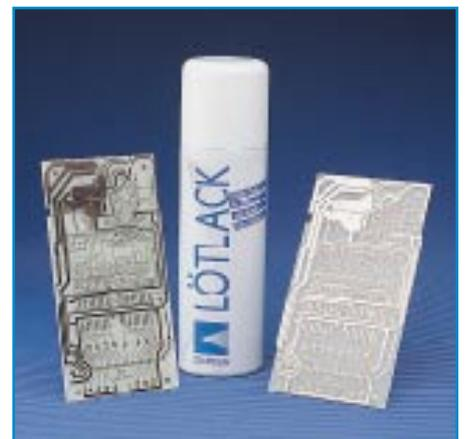
**Bild 9: Der Vergleich einer bereits mangels Schutz korrodierten Platine und einer mit Lötack behandelten Platine macht die Wirksamkeit des Lacks klar.**
