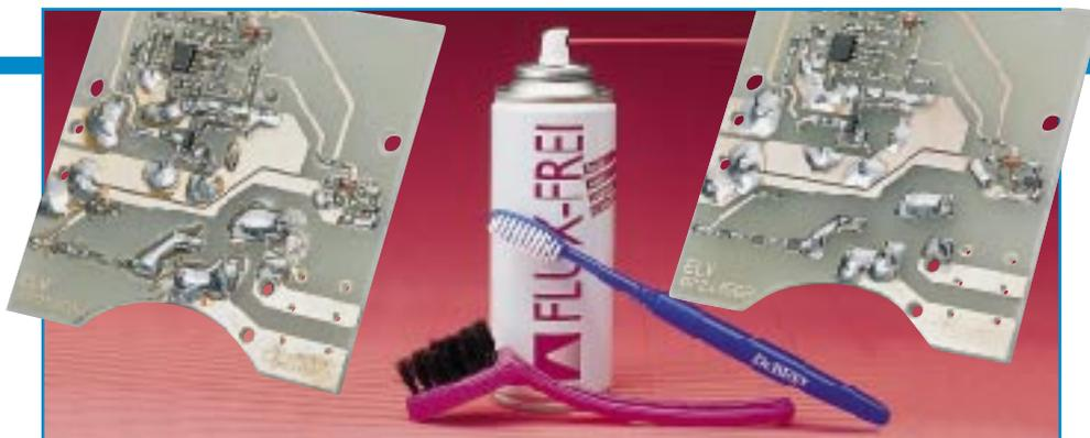
**Bild 10: Der Leiterplattenreiniger sorgt für eine rückstandslose Entfernung von Lötmittrückständen.**
