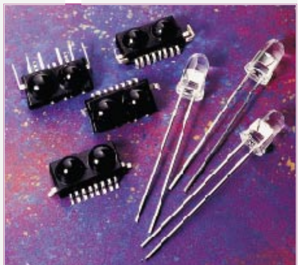
Bild 12: Deutlicher Unterschied - rechts die großen und leistungsfähigen IR-Sendedioden der üblichen Bauform, wie sie auch als Zusatz-Sendedioden Anwendung finden, links die kompakten, vergossenen und eingeschwärzten IrDA-Module mit Sender, Empfänger und integrierter Elektronik.
