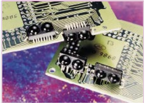
Bild 10: IrDAs werden in den verschiedensten Bauformen gefertigt, um sie optimal an ihre Aufgabe anpassen zu können (Foto: Hewlett Packard)
