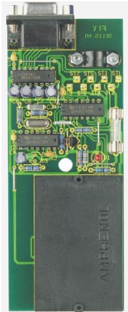
Fertig aufgebaute Platine des PC-Chipkartenlesers
