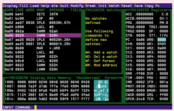
Bild 1: DSP 50-Debugger von Texas Instruments (Public Domain)
