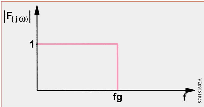
**Bild 1: Amplituden-Frequenzgang eines idealen Tiefpasses**
