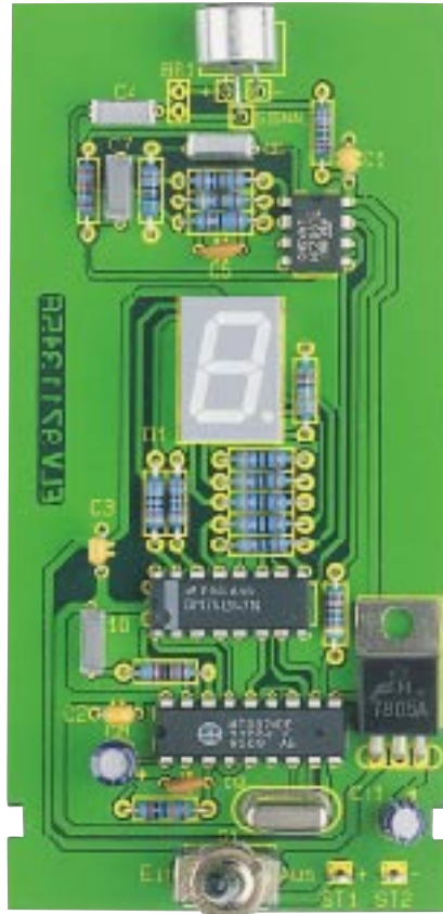
Fertig aufgebaute Platine mit zugehörigem Bestückungsplan
