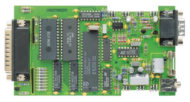
Fertig bestückte Leiterplatte der Lasershow-Anlage LAP 10
