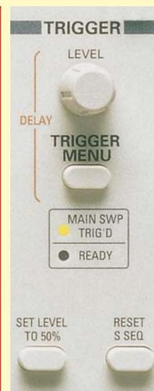
**Bedienelemente und Bildschirmmenü für die Triggersteuerung**
