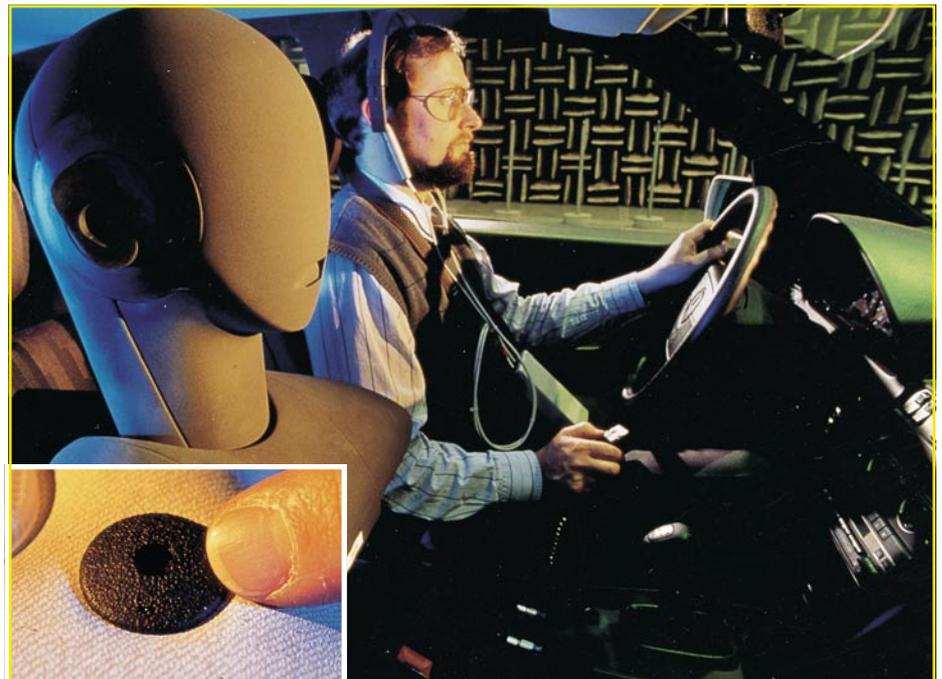
**Bild 7: Im Fahrzeug werden an zuvor sorgfältig ausgetesteten Stellen Mikrofone angebracht. Quelle: Mercedes Benz**
