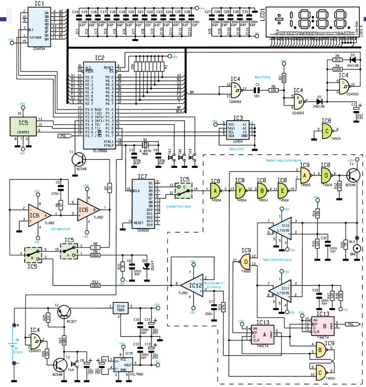
Bild 1: Schaltbild des Digital-Kabellängen-Meßgerätes KM 1
