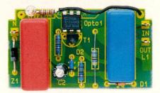
Ansicht der fertig bestückten Platine des Leistungsteils
