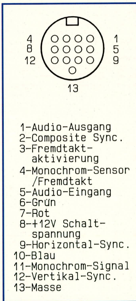
Bild 3: Pinbelegung des Videoausgangs des Atari ST/STE, bezogen auf die Lötseite des zugehörigen Diodensteckers. Die Numerierung ist auf den Steckerkörper aufgeprägt.
