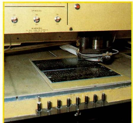
Vollautomatisch werden die Leiterplatten gefräst
