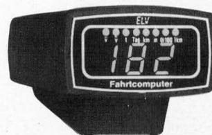
Minuten erhöht sich die Auflösung dieses Meßbereichs auf 0,1 km/h (!) bei Geschwindigkeiten unter 100 km/h.
