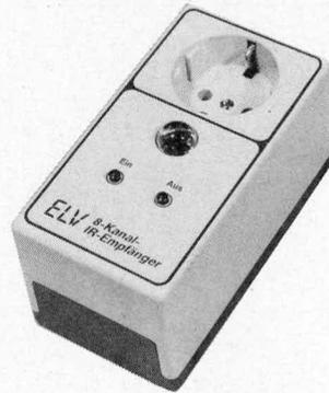
*Mit diesem universell einsetzbaren 8-Kanal-IR-Fernbedienungssystem lassen sich die verschiedensten Fernsteueraufgaben lösen. Angefangen bei Stehlampen, Radios, Fernseher über Kaffeemaschinen, Lüfter, Türöffner bis hin zur Garagentorbedienung kann dieses System eingesetzt werden, das sich darüber hinaus durch eine große Reichweite von ca. 15 m (!) bei hoher Störsicherheit auszeichnet. Der Aufbau ist preiswert und einfach durchzuführen.*
