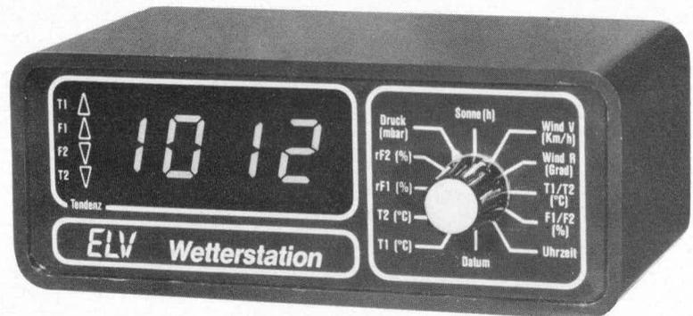
Bei der Elektronik-Wetterstation WS 1000 handelt es sich um ein komfortables, mikroprozessorgesteuertes Wetter-Meßsystem. Beginnend mit der preiswert aufzubauenden Version zur Messung von zwei Temperaturen mit Min-/Max-Speichermöglichkeit kann das System nachträglich weiter aufgerüstet werden. Hier die Maximalmöglichkeiten in Kürze:
