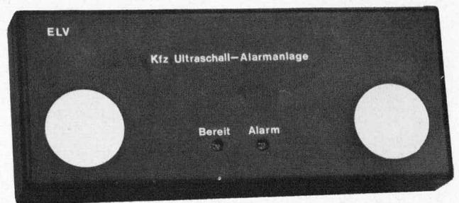
*Speziell zur Raumüberwachung im Kfz-Bereich wurde diese Ultraschall-Alarmanlage konzipiert. Geringe Stromaufnahme und hohe Störsicherheit zeichnen das Gerät u. a. aus.*
