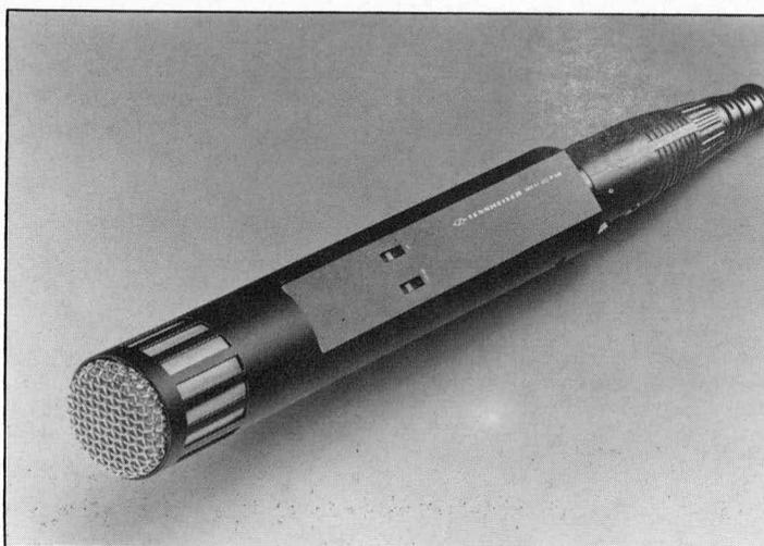
Bild 5.6: Extrem rauscharmes und hochaussteuerbares Studio-Kondensator-Mikrofon MKH 40 P48 mit schaltbarem Roll-off-Filter und 10 dB-Abschwächer (Werkfoto: Sennheiser electronic). Das MKH 40 ist ein Gradientenmikrofon mit Nieren-Richtdiagramm
