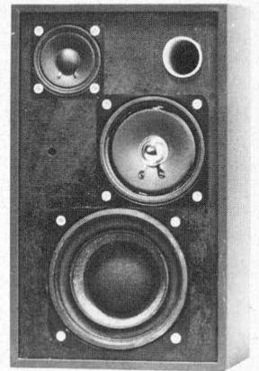
*Drei integrierte Leistungsverstärker mit vorgeschalteten elektronischen Filtern sowie ein eingebautes Leistungsnetzteil, bilden in Verbindung mit drei hochwertigen Lautsprechersystemen die wesentlichen Komponenten dieser im ELV-Labor entwickelten außergewöhnlichen HiFi-Aktivbox mit kompakten Abmessungen.*
