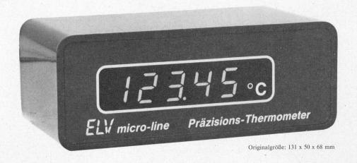
Eine absolute Genauigkeit von typ. 0,02 K bei einer Auflösung von 0,01 K im Bereich von -50° bis + 200° C, dürfte eine Sensation auf dem Sektor der elektronischen Temperaturmeßtechnik darstellen, besonders dann, wenn man den verhältnismäßig günstigen Nachbau berücksichtigt.
